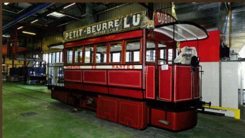
Nantes, Wagen 22 von vorn: An der Plattformwand befindet sich das Spitzenlicht mit kombinierter Innenleuchte. Das Triebwerk der Vorderachse ist verschalt
