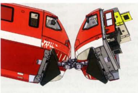
Überprüfung der Kollisionsfreiheit von Kabine zu Kabine und von Kabine zu Kupplung (Screenshot: Nose).
