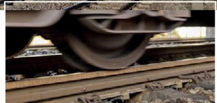
Die Messung der Unrundheit der Räder erfolgt mittels Dehnmessstreifen an der Schiene.
