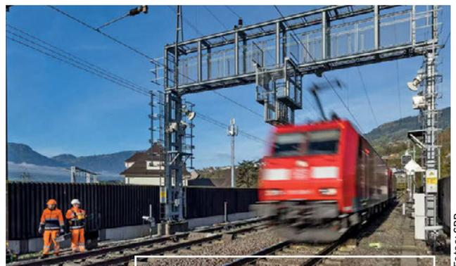
Mit Laserscannern wird das Lichtprofil des Zuges bei Streckengeschwindigkeit überwacht.
