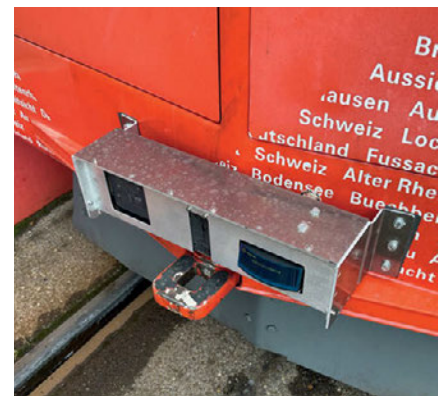
Das provisorisch montierte Gehäuse mit den Sensoren für das System Stadler NOVA Smartsense
