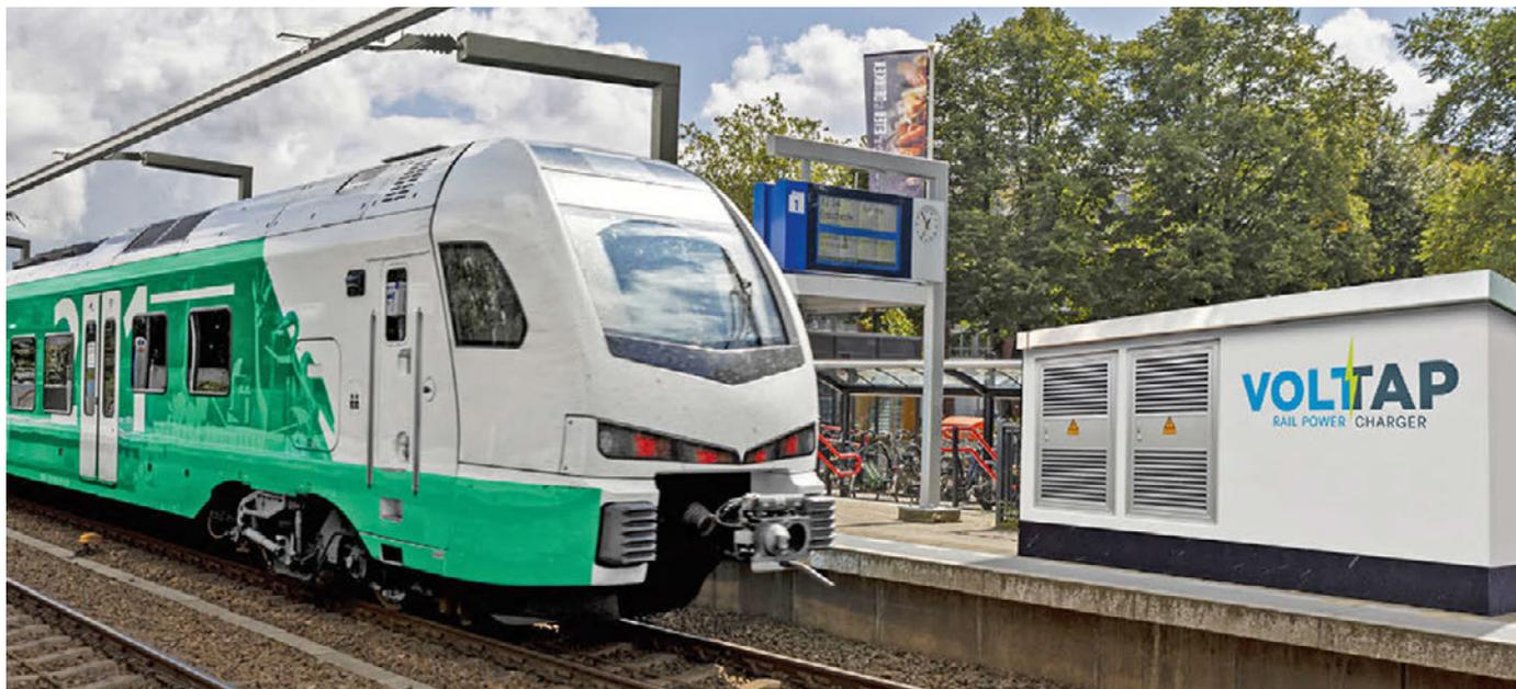
4: Die Visualisierung einer Ladestation. Ein BEMU (Flirt Akku) von Stadler lädt an einer VOLTAP-Schnellladestation
